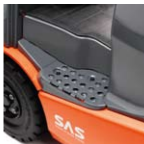
Escalón de baja altura
