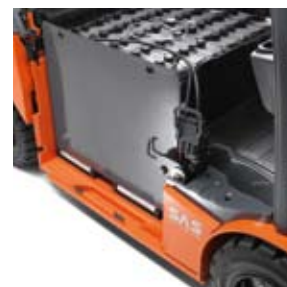
Extracción lateral de la batería con ayuda de rodillos
