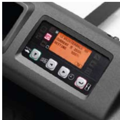
Contador de horas para determinar intervalos de mantenimiento
