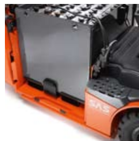
Extracción lateral de la batería con ayuda de aberturas para horquilla
