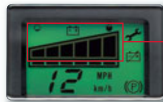
Medidor de capacidad de la batería
