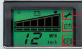
Símbolo de llave fija Indicador de recarga de la batería Luz indicadora de freno de estacionamiento activado
