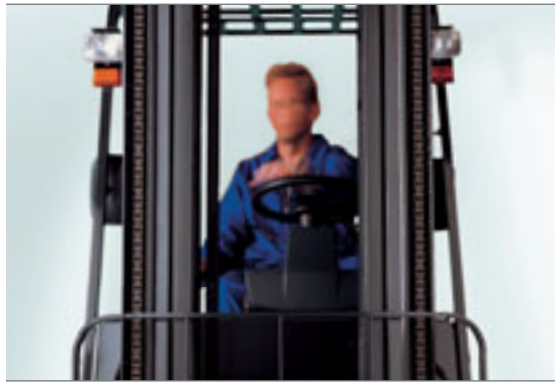
El mástil de dos etapas de amplia visión, con las cadenas de elevación montadas en la parte exterior del mástil, ofrece una mayor visibilidad
